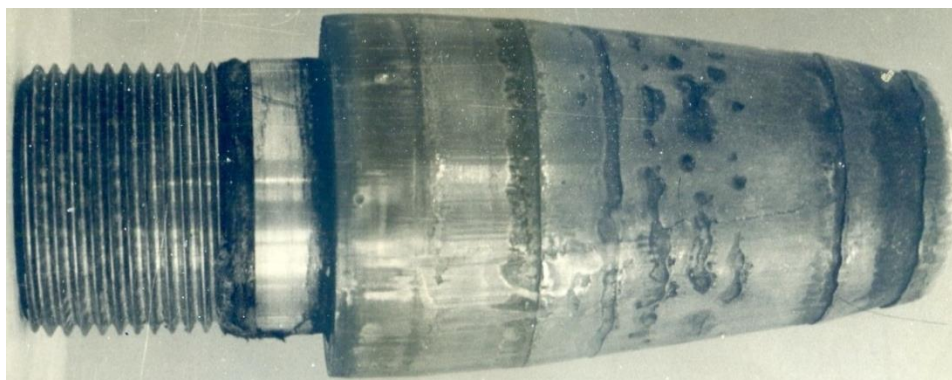
Рис. 1. Прошивной пуансон изготовления трубы из медного сплава
